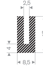
Artikelcode 3922100130 Kwaliteit CR Hardheid 15° Shore Kleur Zwart Lengte 50 meter
