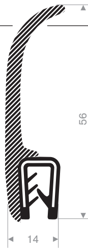
Artikelcode 3924500876 Kwaliteit Vol- + Moosrubber EPDM Klembereik 1-3 mm Kleur Zwart Lengte 25 meter
