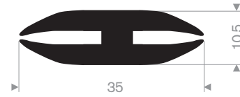
Artikelcode 3921202150 Kwaliteit EPDM Hardheid 70° Shore Kleur Zwart Lengte 25 meter
