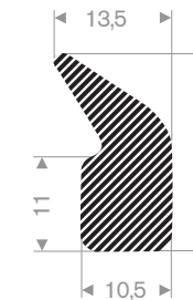
Artikelcode 3922500640 Kwaliteit EPDM Hardheid 15° Shore Kleur Zwart Lengte 50 meter
