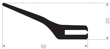
Artikelcode 3921109175 Kwaliteit EPDM Hardheid 65° Shore Kleur Zwart Lengte 50 meter
