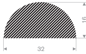
Artikelcode 3922501200 Kwaliteit EPDM Hardheid 15° Shore Kleur Zwart Lengte 25 meter
