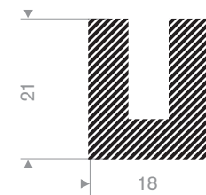
Artikelcode 3922100160 Kwaliteit EPDM Hardheid 15° Shore Kleur Zwart Lengte 50 meter
