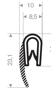
Artikelcode 3924500100 Kwaliteit PVC + Moosrubber EPDM Klembereik 1,5-3 mm Kleur Zwart Lengte 50 meter
